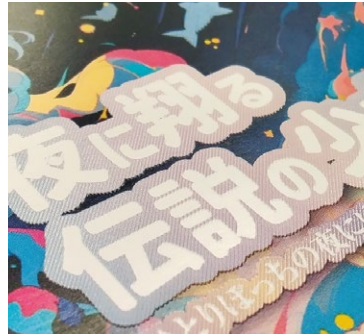
隆起印刷…透明インキを重ねてエンボス加工のような凹凸の表現が可能。
