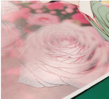
隆起印刷…透明インキを重ねてエンボス加工のような凹凸の表現が可能。
